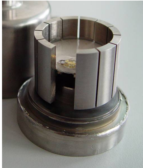
Figur 5.2 Piezoelektrisk accelerometer av skjuvtyp.
